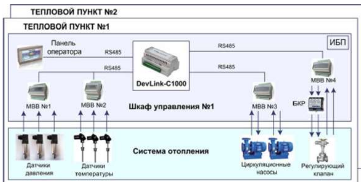
Сурет 1.4 – Жылу пунктінің өзара әрекеттесу сызбасы
